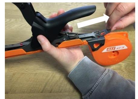
Nehmen Sie die Heftklammern und legen Sie sie so in das Magazin ein, dass die Enden nach oben zeigen.
