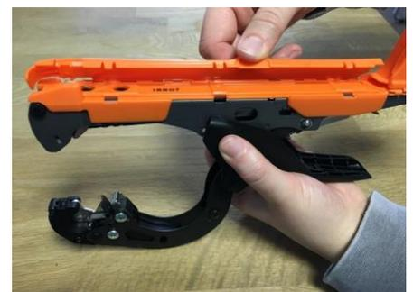
Öffnen Sie zusätzlich das Bandgehäuse mit dem Zeigefinger an der Lasche, wobei der Daumen mittig festhält.
