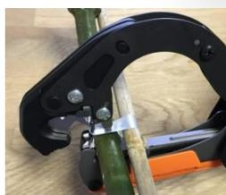
**Verschenden Sie nicht unnötig Ihre Kraft! Der Bandgreifer holt das Band bei nur leichtem Antippen. Zu starker Druck schadet der Bindezange.**
