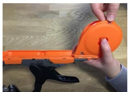
Legen Sie die Bandrolle ein und schließen Sie beide Abdeckungen so, dass sie hörbar einrasten.
