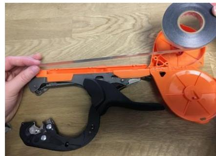
Legen Sie das Band in die zwei Führungsschienen der Bandführung ein.
